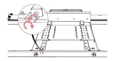
10mm Spanner/ 3mm Allen Key CW - LOCK CCW - UNLOCK
